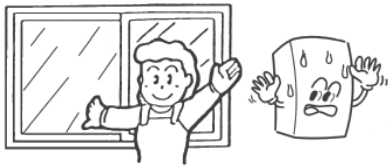
室内不得安装室外型热水器
